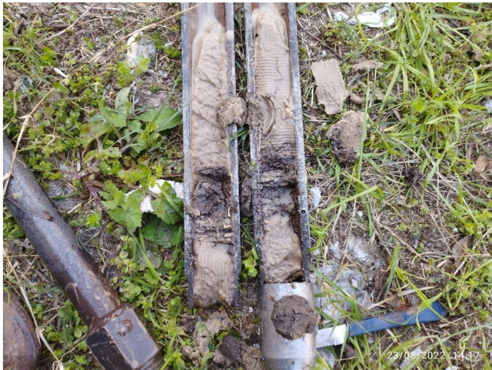
Figura 6 – Solo característico identificado na sondagem SP-02.
