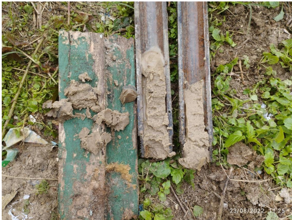
Figura 4 – Solo característico identificado na sondagem SP-01.
